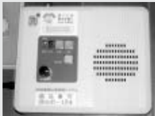
西白沢公民館：無線放送施設設置
