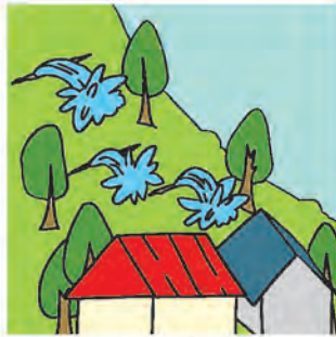
斜面から水が噴き出す。
