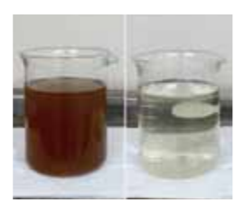
(左) 処理前の水 (右) 処理後の水 処理場では約1日半かけて水をきれいにします。
